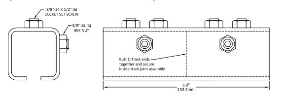
BOLTED TRACK JOINT ASSEMBLY FC-CH2D
